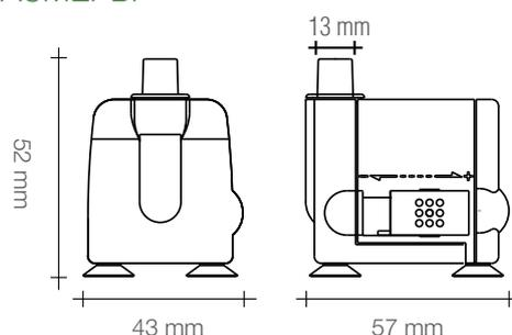
MICRA и MICRAPlus можно подсоединить к жесткой трубке с внутренним диаметром 13 мм или при помощи переходника, входящего в стандартный комплект, к гибкому шлангу с внутренним диаметром 12 мм.
