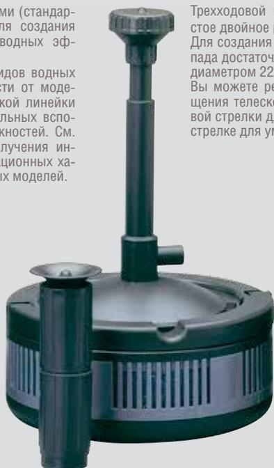
Трехходовой клапан, обеспечивающий простое двойное регулирование расхода воды. Для создания небольшого ручейка или водопада достаточно подсоединить гибкий шланг диаметром 22 мм к боковой насадке клапана. Вы можете регулировать расход путем вращения телескопической трубки против часовой стрелки для его увеличения и по часовой стрелке для уменьшения.
