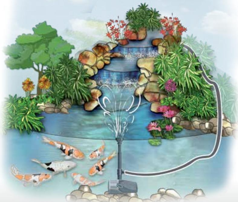
Для создания небольшого водопада или ручья, достаточно подключить к боковому патрубку клапана шланг диаметром 22мм. Вы можете регулировать поток поворотом регулятора в положение «+» или «-», обозначенные на корпусе клапана.
