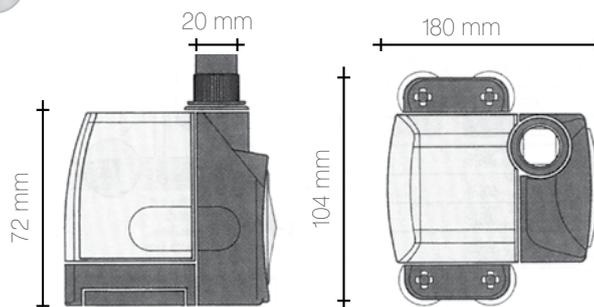
в комплекте, EXTREMA и SUPREMA можно подсоединить к гибким шлангам с внутренним диаметром 20 мм.
