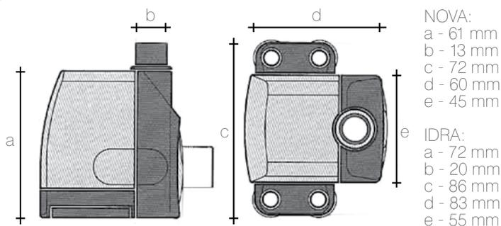
Насосы NOVA и IDRA можно подключать к жестким трубкам (внутренний диаметр NOVA 13 мм / IDRA 20 мм), при помощи переходника, входящего в стандартный комплект поставки, к гибким шлангам с внутренним диаметров 12 мм (NOVA), 20 мм (IDRA).
